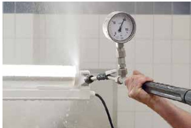
> Hochdruckreinigung des Gehäusedeckels mit 100 bar
